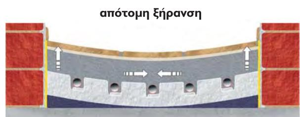
Αφού, λοιπόν, πετύχουμε τη μέγιστη θερμοκρασία (50°C) σταδιακά μειώνουμε τη θερμοκρασία κατά 10°C κάθε ημέρα, ως το σταμάτημα της λειτουργίας της εγκατάστασης.
