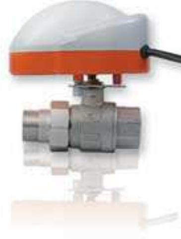
Ο μηχανισμός περιλαμβάνει ηλεκτρονόμο (ρελέ 220V) δύο τερματικούς διακόπτες ακριβείας, έκκεντρο εντολών, ηλεκτρομειωτήρα ειδικά σχεδιασμένο με το πλεονέκτημα του μηχανικού stop στον ηλεκτροκινητήρα και μεγάλη ροπή στρέψης στο σύνολό του (5NM).
