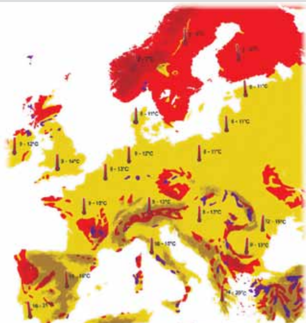
Μέση θερμοκρασία υπεδάφους για βάθος 10m-150m
